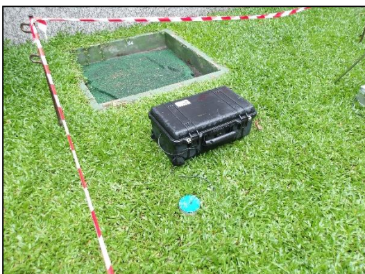
รูปที่ 4.6 การตรวจวัดความสั่นสะเทือน บริเวณโรงแรมแอสคอตท์ ทองหล่อ บางกอก
