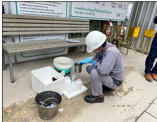
รูปที่ 4.7 การเก็บตัวอย่างคุณภาพน้ำทิ้ง บริเวณบ่อกักน้ำสุดท้ายก่อนระบาย ออกจากโครงการ
